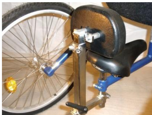
Litet stöd monterat bakom sadeln.
